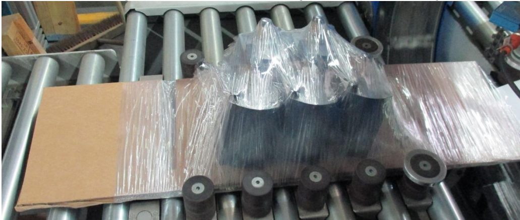
Schritt 2c: Fixierung der Produkte auf dem Inlay mittels Stretchfolie per Umreifung
