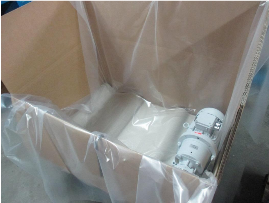
Abb. 3: Europalette mit Palettenkarton, mit PE-Folie ausgekleidet
