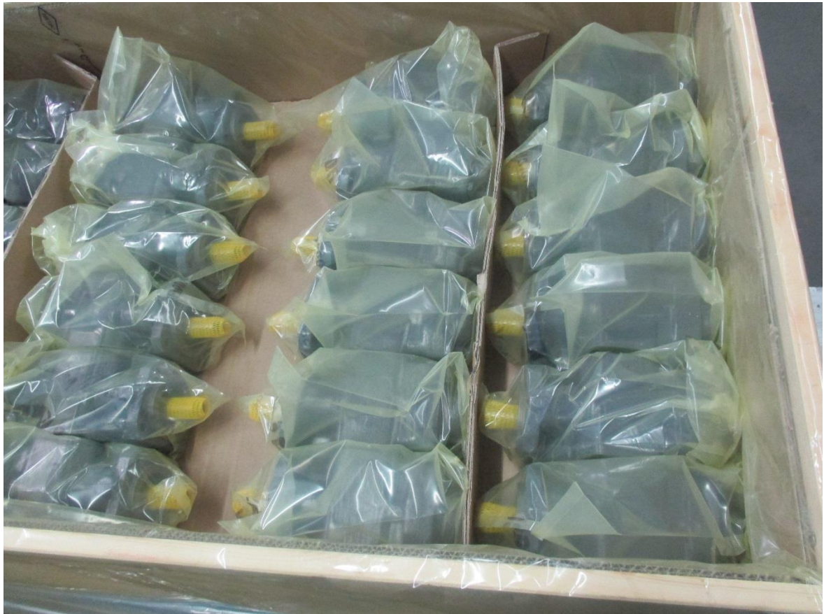
Abb. 7: Produkte im Korrosionsschutzbeutel (VCI-Beutel)
