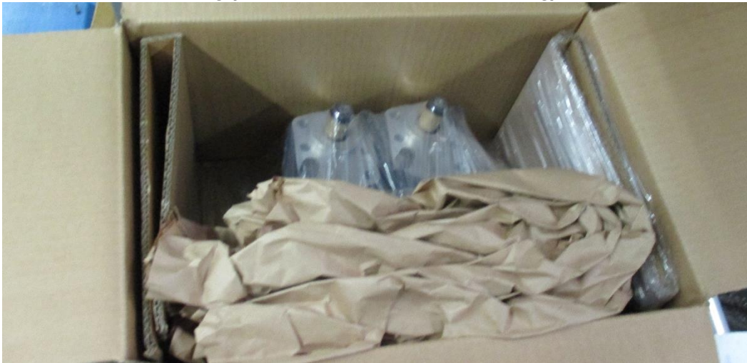
Schritt 3b: Kartonfüllung (Füllmaterial zur weiteren Fixierung)
