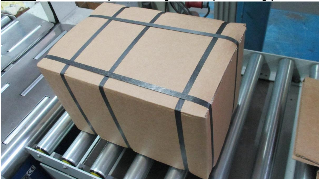
Schritt 4: Kartonverschluss (Bandumreifung: bis zu 3x quer u. 2x längs)
